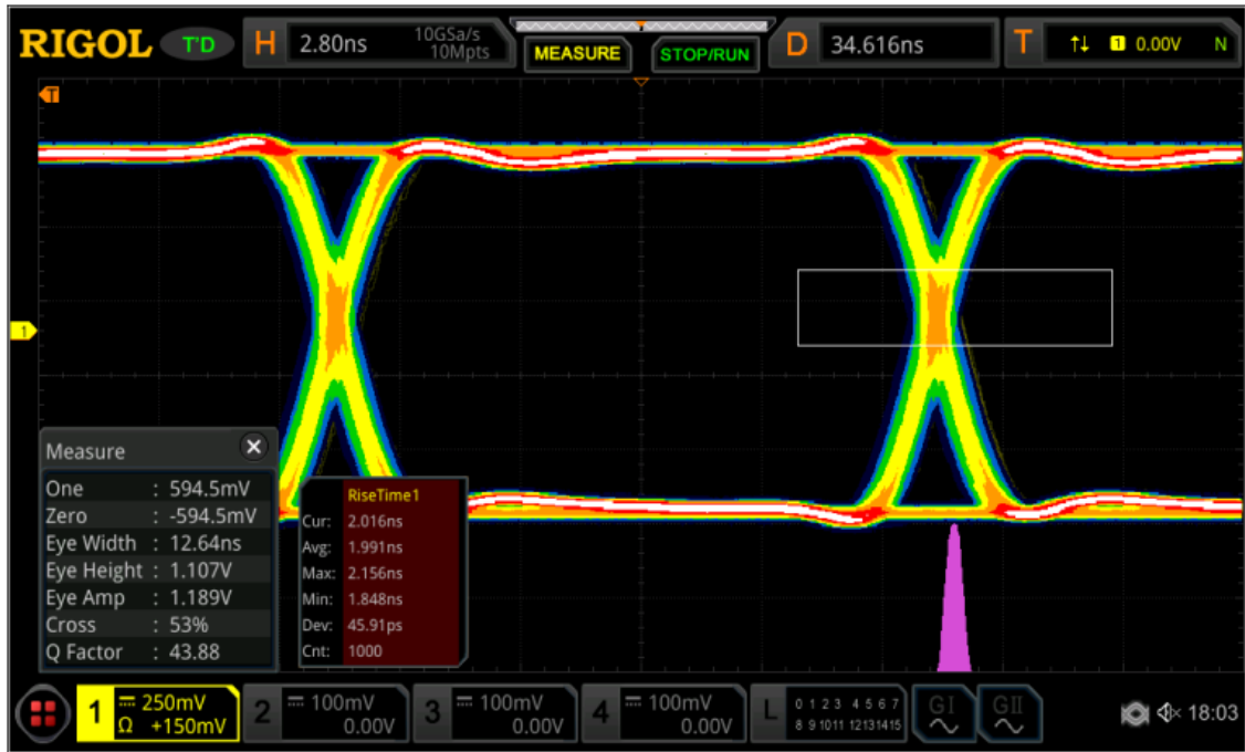
그림 5. 시스템의 Deterministic 지터 성분을 개선한 아이 다이어그램
