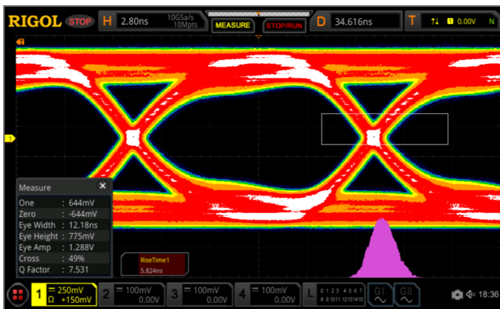
그림 3. 랜덤 성분의 지터가 개선된 아이 다이어그램
