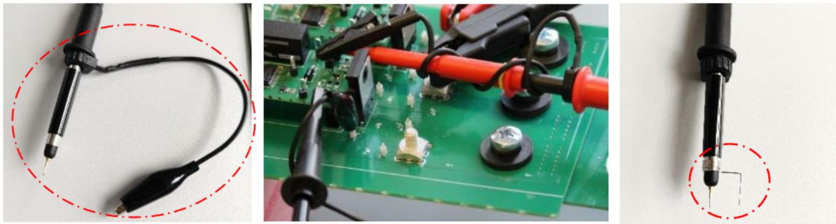
그림 16. 큰 루프를 갖는 수동 프로브(좌측)와 이를 개선하기 위한 대책(중앙 및 우측)을 적용한 DPT 전압 측정
